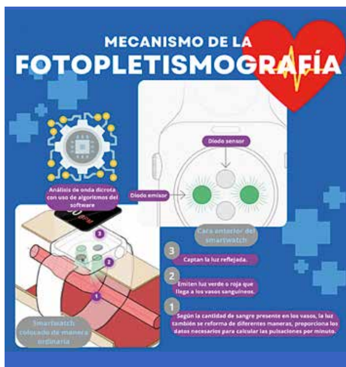
Figura 1. El reloj inteligente utiliza un sistema optoelectrónico para obtener información de la onda de pulso sanguíneo.
